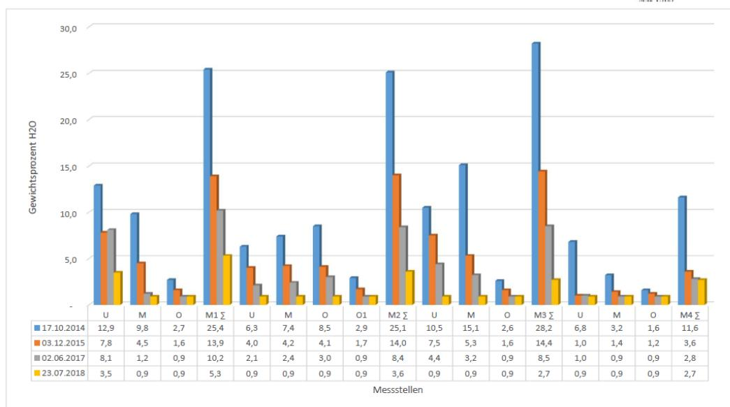
Messungen wurden nach der DARR-Messmethode durchgeführt. Die ÖNORM B3355 führt die DARR-Methode als das einzige gültige Verfahren an, das präzise die Mauerwerk gebundene Feuchte misst.
